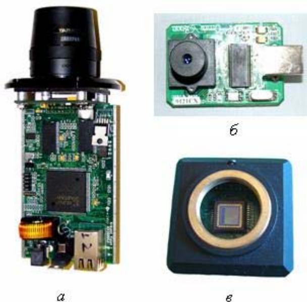
Рис. 14. Телекамеры на КМОП фотоприёмниках
